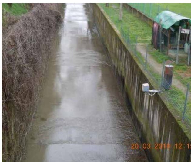
Fig. - Immagini in corrispondenza dello scolmatore e del relativo sensore di livello (a sinistra) e del canale di Reno verso Bologna con il relativo misuratore di livello (a destra).
