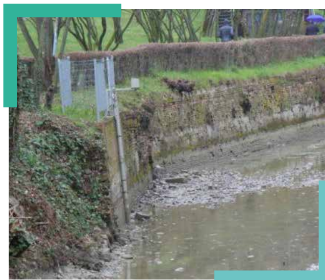
Fig. - Immagini in corrispondenza dello scolmatore e del relativo sensore di livello (a sinistra) e del canale di Reno verso Bologna con il relativo misuratore di livello (a destra).
